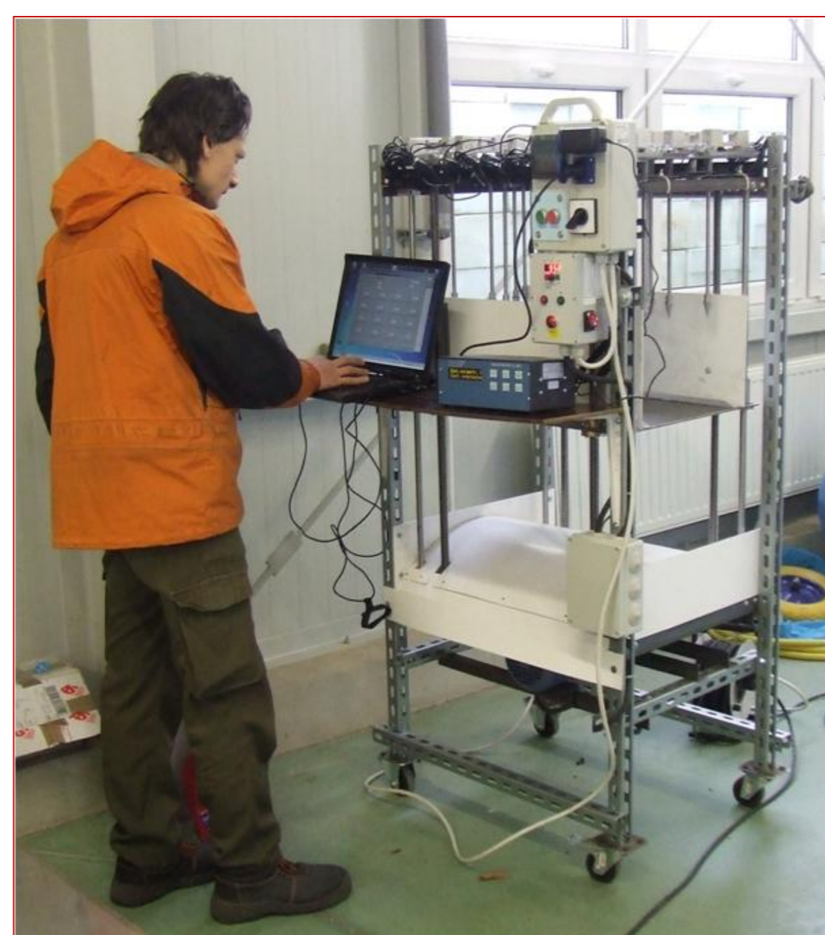
Ryc. 1. Prototypowe stanowisko do pomiaru zwięzłości w kasetach (Zgłoszenie nr: P.441918)
