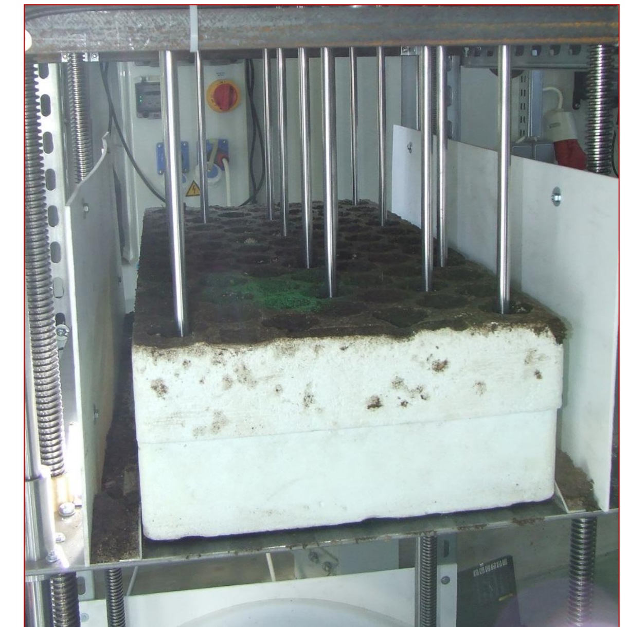
Ryc. 6. Pomiar zwięzłości substratu Multipenetrometrem w kastach styropianowych Marbet
